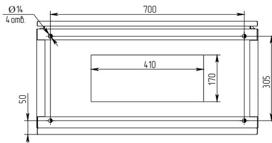
г) ШУ мощностью 90 – 250 кВт, вид снизу
